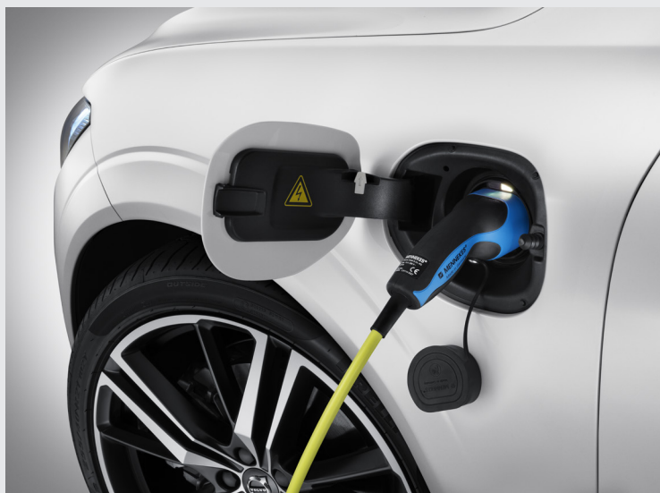
Zásuvka na nabíjanie batérie na ľavom prednom blatníku
